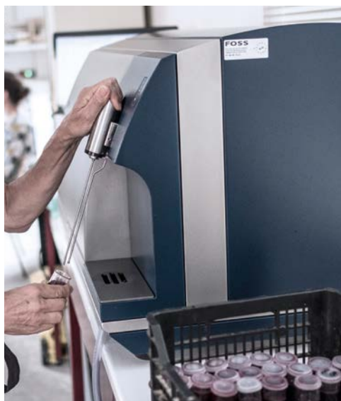
Das FTIR-Gerät WineScan der Fa. Foss liefert den vergärbaren Zucker direkt
