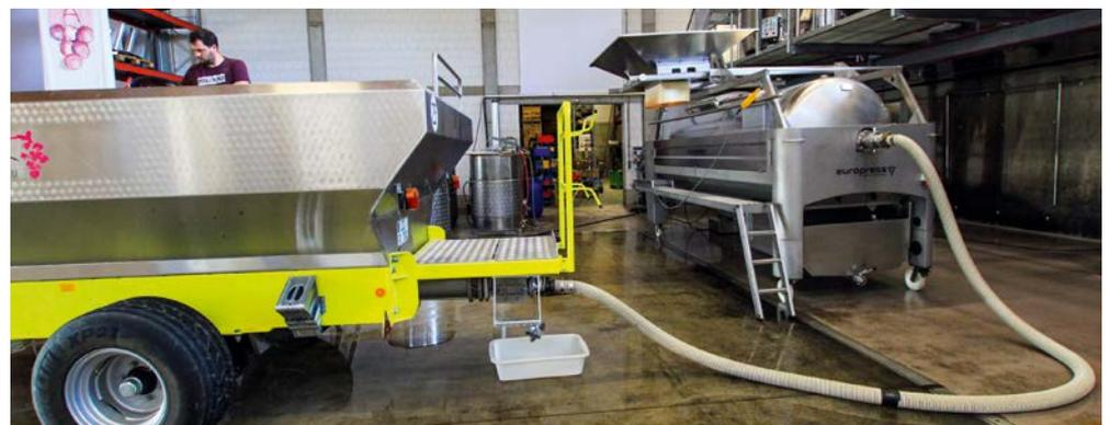
Eine der Standardsituationen: Beschickung der Presse über die Zentralbefüllung
