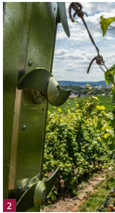
2 Clemens: robuste Messerform (li.) und leichter Ersatz des Keilriemens
