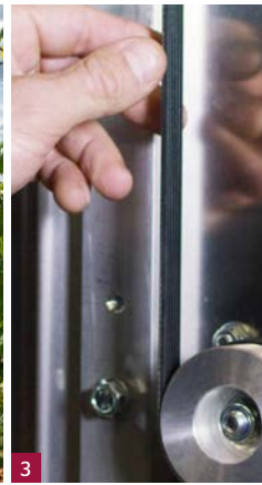
2 Clemens: robuste Messerform (li.) und leichter Ersatz des Keilriemens
