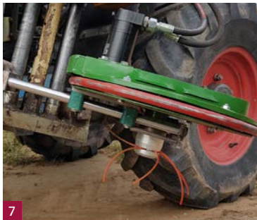
Unterstocklösungen von Leckron: Unterstockmäherwerk (7) und Rollhacke (8)
