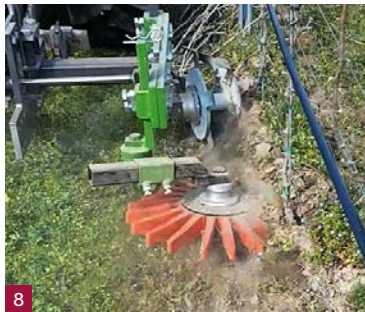
Unterstocklösungen von Leckron: Unterstockmäherwerk (7) und Rollhacke (8)
