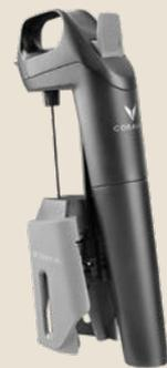
Mit einer dünnen, hohlen Nadel wird durch den Korken gestochen, während dieser in der Flasche verbleibt. Durch die schmale Röhre fließt die gewünschte Menge Wein, das Edelgas Argon wird gleichzeitig in die Flasche gestoßen, um den entstandenen Leerraum aufzufüllen und Oxidation zu verhindern. So werden die Weine über einen längeren Zeitraum konserviert.
